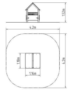
Die Tragkonstruktion des Hauses wird aus Baustahl hergestellt (Metallprofil 100 x 100 mm), die gegen Korrosion mit Zinkbeschichtung geschützt wird, womit es einer wesentlichen Verlängerung der Lebensdauer des Spielelements gezielt wird. Diese Konstruktionen werden im Beton befestigt. Alle anderen Metallelemente werden auch verzinkt und im eingebrannten Pulverlack KOMAXIT in RAL-Farben oder mit Feuerverzinkung ausgeführt.
