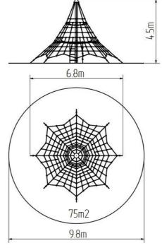
Der Mittelmast der Seilpyramide besteht aus feuerverzinktem Konstruktionsstahl und wird im Beton verankert. Die Seile bestehen aus HERKULESTAU (16 mm Seil aus Polypropylen mit Stahlkern) und werden durch Kunststoff- oder Aluminiumverbindungen verbunden. Die Sicherheits-Spannschlösser sind aus Edelstahl. Alle Verbindungselemente sind verzinkt oder aus Edelstahl.
